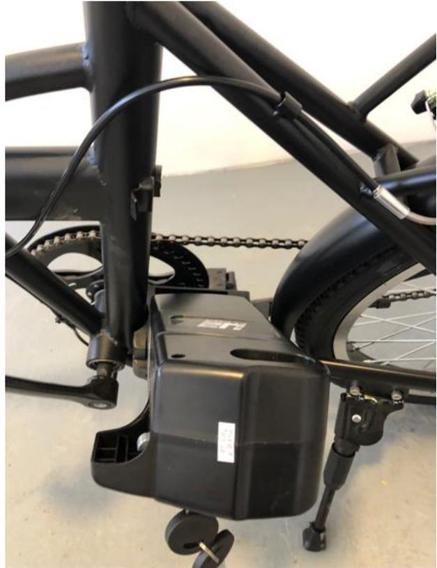
1.3 - Inserción correcta de la batería: Insertar la batería en la caja porta batería encastrando en los pines correspondientes. No se olvide de bloquearla en el cuadro antes de utilizar el vehículo para evitar el riesgo de robos de la batería durante un estacionamiento en la ciudad.
