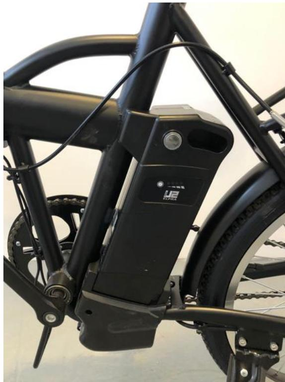
1.1 Modo de cargar la batería: Primero conecte la batería al cargador y luego conecte el cargador a la red eléctrica.
